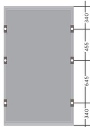
Dans cette variante de montage, le module peut entrer en contact avec les rails de montage en raison de la charge élevée. Pour éviter d'endommager le verre, il faut donc prévoir un revêtement en gomme sur les rails.
