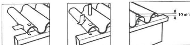
Le capuchon d'étanchéité est alors mis en place sur l'entretoise, puis l'Adaptateur Universel M8 est fixé conformément au sens prévu pour les rails (parallèlement ou perpendiculairement à l'onde) - la partie centrale de l'adaptateur est posée contre la couverture, les ailes orientées vers le haut.
