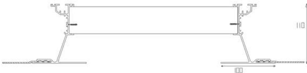
L'assemblage des bandes de raccordement sur le rail de fixation est réalisé par un double procédé d'écrasement et de clinchage
