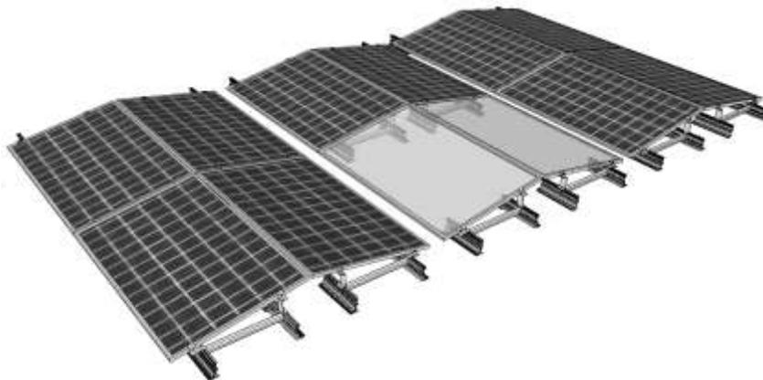
14- Répéter l'opération en utilisant des brides centrales pour soutenir deux modules cotes à cote. Ils seront fixés par l'intermédiaire des brides latérales, sur chacun de inclineurs, en utilisant une vis CHC M8X 40mm (pouvant varier en fonction de la hauteur du cadre) + Rondelle crénelée + écrou M8, positionné dans la gorge de chacun des inclineurs haut et bas. Serrer
