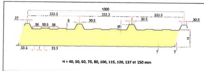
Concernant les éventuels autres profils de couverture que ne serait pas référencés spécifiquement ci-avant, la société JORISIDE peut donner son accord au cas par cas à d'autres profils de couverture (incluant les Profils en Tôles acier Nervurée et les panneaux sandwichs avec mousse PIR), pour autant qu'ils satisfassent aux contraintes suivantes qui constituent un prérequis indispensable :
