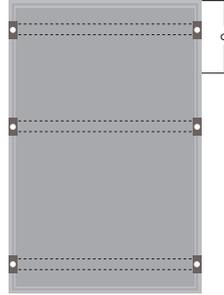
Installer le rail intermédiaire en respectant un décalage de 50 à 80mm avec le centre du panneau (pas d'interactions avec les boîtes de jonction)
