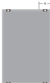
**Charge de pression** (charge d'essai) et **Charge de succion** maximale admissible en Pa en fonction de la distance (a) en mm.
