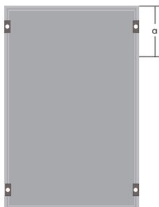
**Charge de pression** (charge d'essai) et **Charge de succion** maximale admissible en Pa en fonction de la distance (a) en mm.
