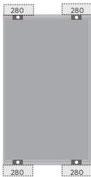
Charge de pression maximale admissible jusqu'à 1.067 Pa
