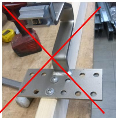
Figure 35: Essai de fixation de crochet sur un arbalétrier de fermette trop fin
