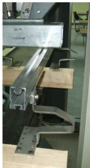
Figure 22: Test de résistance de crochets installés en porte à faux
